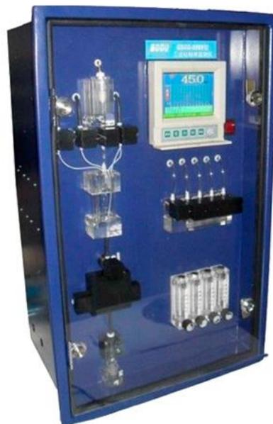
Este analisador em linha de hidrazina, é um instrumento que pode determinar automaticamente a reação química, Detecção ótica, indicador gráfico, saída de controle, e capacidades de armazenamento de dados de alta precisão.
