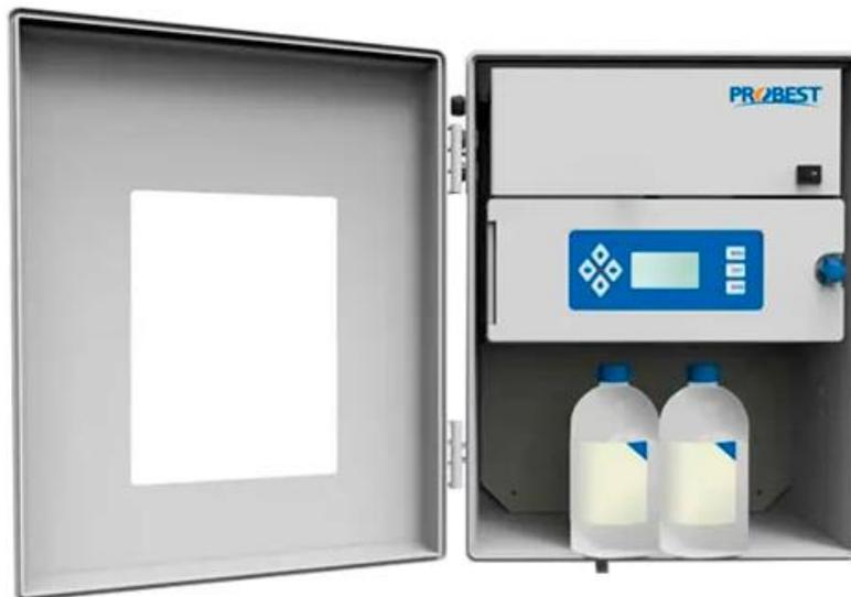
O CL - 201 adota DPD colorimétrico para medir a concentração de cloro residual. Um analisador de alta precisão e desempenho, com baixa manutenção. Amplamente utilizado na medição de cloro residual nas estações de tratamento de água potável e para indústrias. Consumo de reagentes de 500mL a cada 30 dias.
